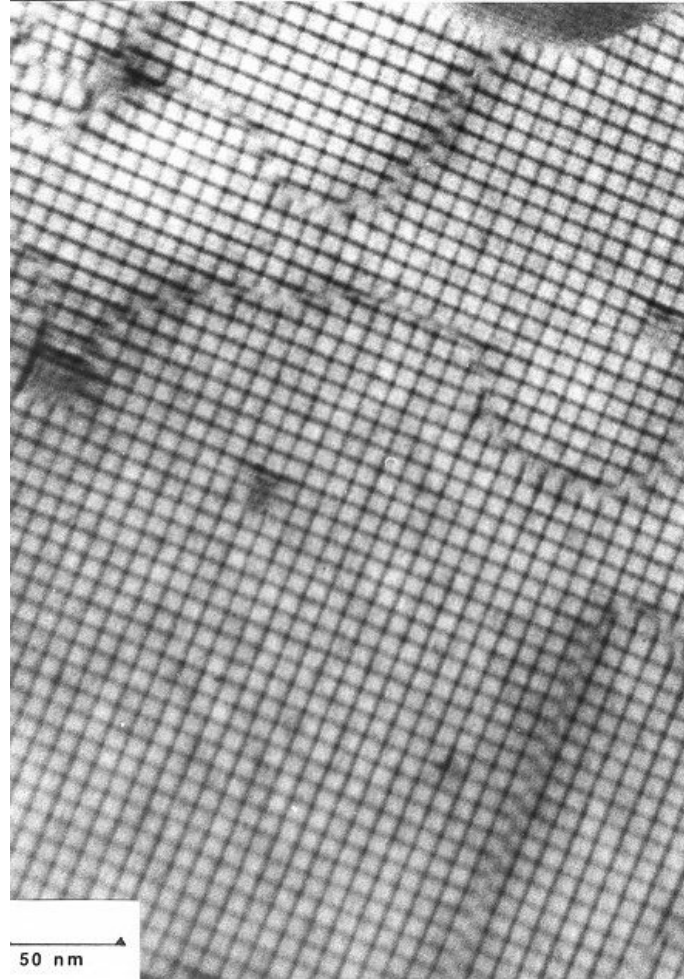
Schrauben VS (leichte Drehung der \{100\} Ebenen)
